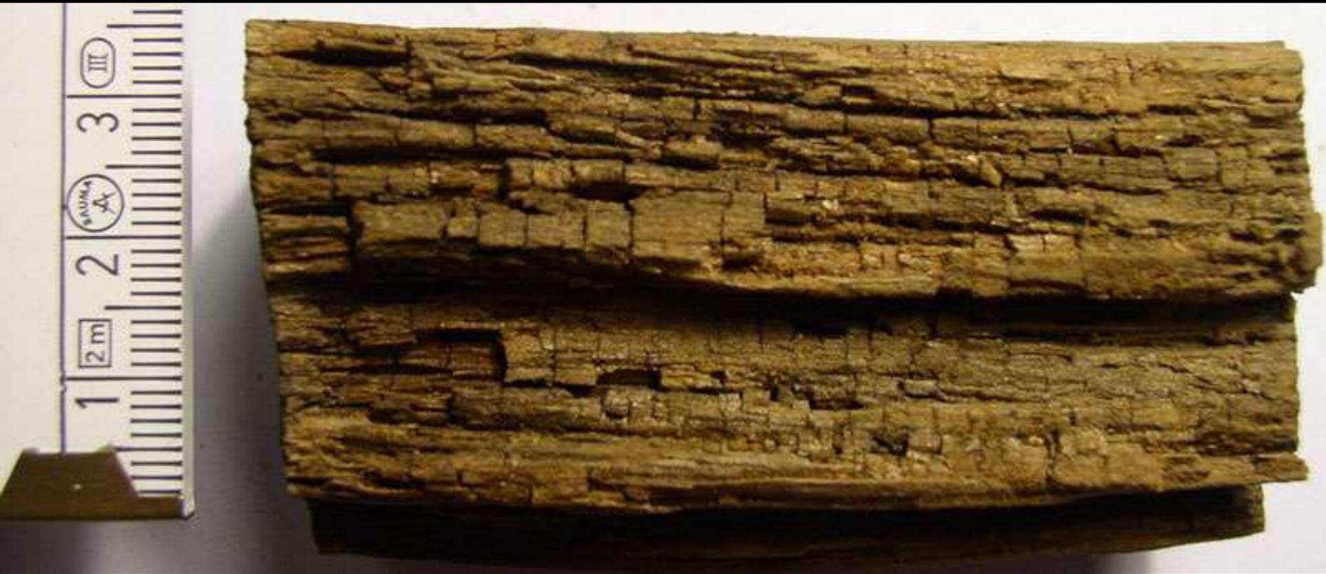
Durch Moderfäule zerstörtes Holz, getrocknet
